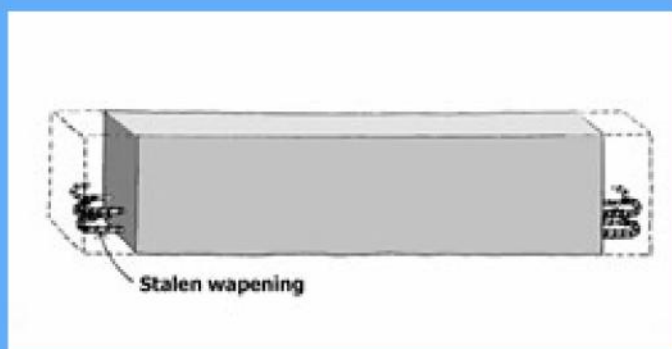
Staal in een staalbetonnen ligger neemt trek op.
